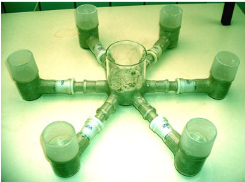
Abb.2: Das sechsarmige "Olfactometer": In der Mitte werden die Nematoden freigesetzt und bewegen sich dann in einen der sechs Arme.
